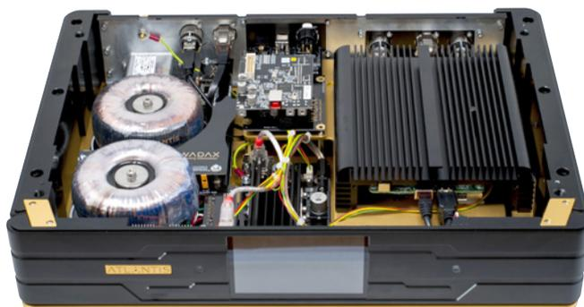
重的設計卻會造成嚴重破壞，就以機器結構為例，機箱內遞增的溫度、機箱使用的合金質量、記憶模塊、處理器和供電線路等，所有部份產生出的殘餘噪聲是會通過數碼輸出端子，傳輸至其他器材，這些由數碼輸出傳開的噪聲最終會變成為Jitter及噪音調制器（簡單來說即是來源頻率變調成為射頻），由此可知牽連的禍害就像火燒連環船，所以Javier把Server視為整套系統的其中一部份，而非獨立一部播放器材，機體和線路均採用與解碼器同等高規格製造，換言之，Javier是從整體著手處理噪聲問題，他採用相同質量的合金製造機箱，機內線路規劃盡量達到一致，繼而在每個機箱頂部裝嵌有四個金屬圓腳頂座，機背亦設有接地端子，當四部器材疊放時便形成了機械接地
