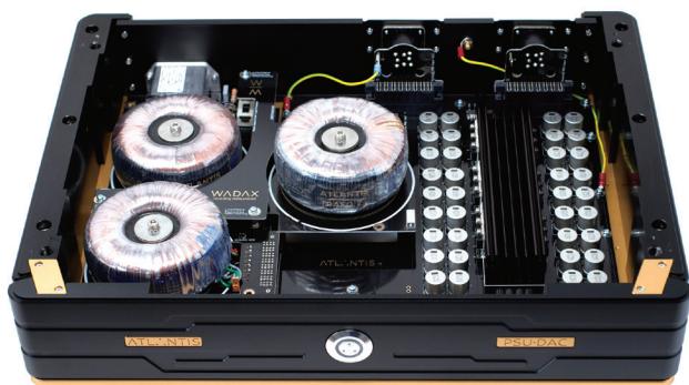
分体电源中使用了三个变压器和独家电网噪声抑制技术，双声道独立供电；机身通过 FEA 有限元分析技术达到抗震和屏蔽效果，500 多个元件组成的电源堪称有史以来解码器之最。
