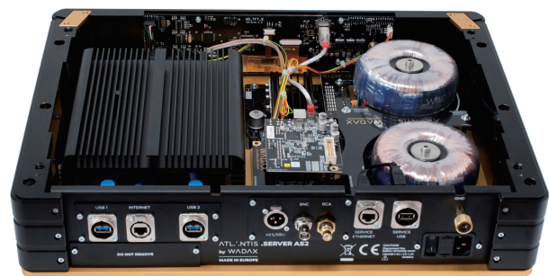
和 Atlantis 解码器相同的极致级电源设计；支持 WAV、WAV64、AIFF、FLAC、ALAC、OGG 等音乐格式，内置 1TB SSD 硬盘，机身是无风扇散热铝制结构；采用 Roon 作为音乐管理软件；可通过 DLNA 和 USB 读取音乐，并支持 TIDAL、Spotify 及 MQA 等主流串流高清音乐应用。背后接口包括了 AES/EBU、RCA 同轴、BNC 同轴。二个 USB 口一个接解码器，另外一个接外置硬盘或 U 盘
