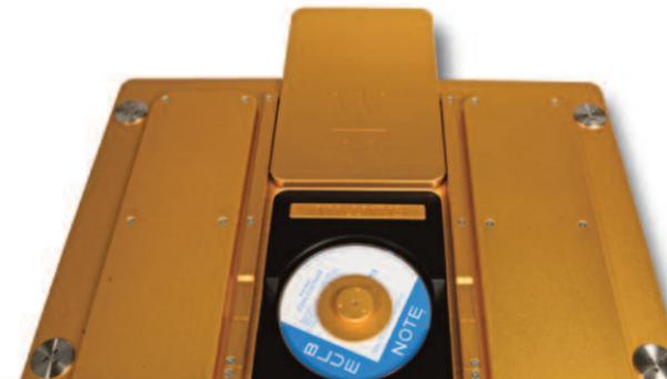
Le chargement du support en quatre images. À la demande d'ouverture par appui sur l'afficheur ou sur la télécommande, la trappe supérieure glisse vers l'arrière du Transport. Une fois ouverte, la partie haute de la mécanique Thor s'élève progressivement jusqu'à émerger de quelques centimètres hors du châssis. Une fois le support en place sous le palet presseur aimanté, il suffit de commander la fermeture pour que le scénario déroule en sens inverse.
